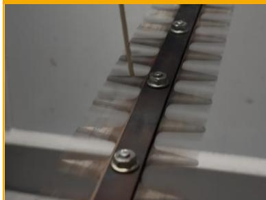
竹ひごを2,500回連続で切断する切れ味試験、100時間連続で運転させる耐久試験、60時間のフィールドテストの計160時間をクリアした信頼の品質。
