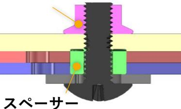
スペーサーを搭載することで一定の圧で刃を抑え、切れ味抜群。特殊ナットは緩み止め性能が高く、従来のナットに比べ使用中の緩みを大幅に軽減。
