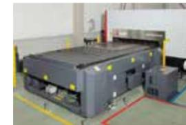
▲ 炭酸ガスレーザー加工機
